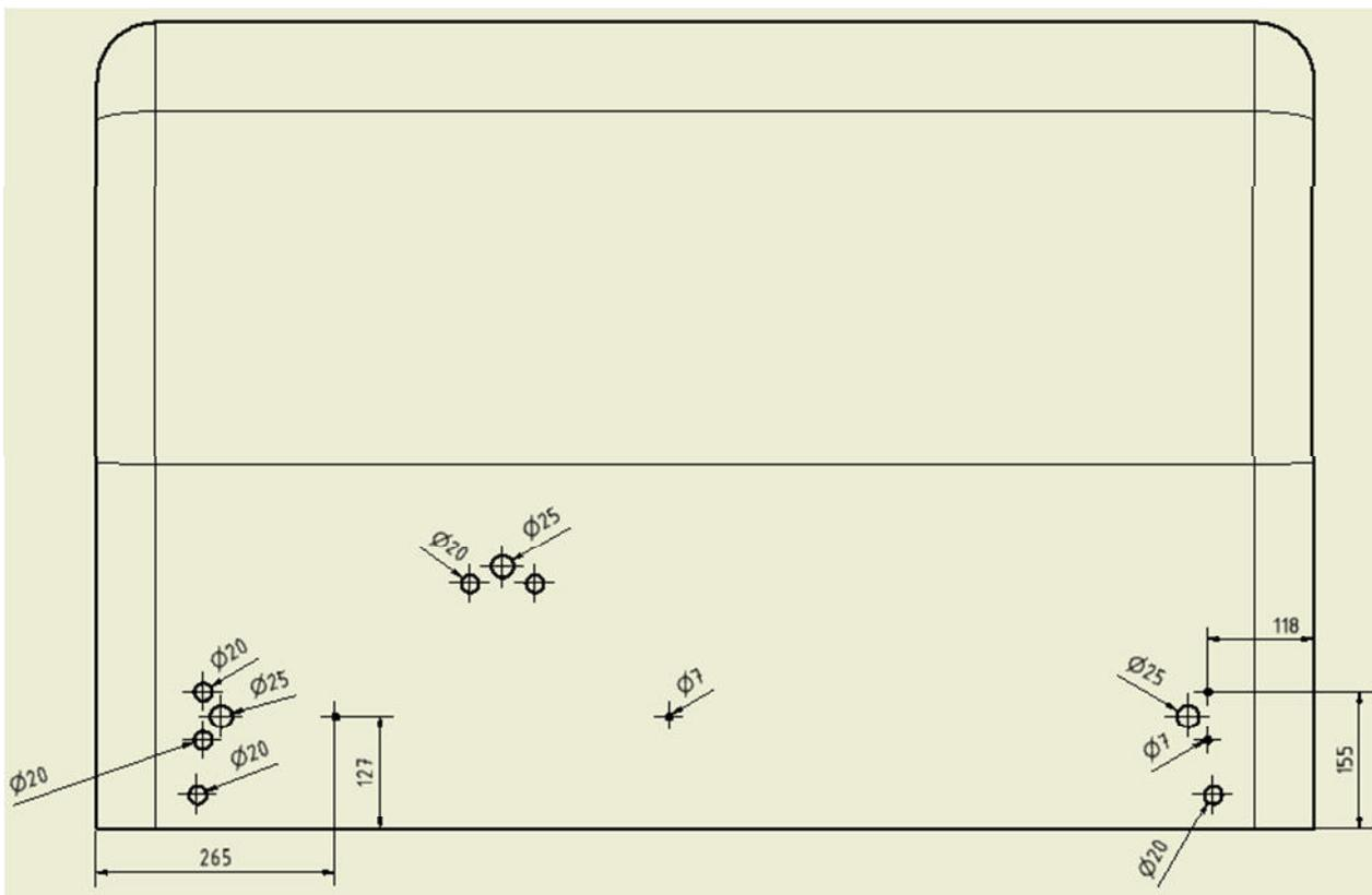
3. Lampen und Rückstrahler erst auf die Halterungen montieren und anschließend Halterungen auf den Spoiler montieren. Die Befestigung der Lampen auf dem Spoiler erfolgt lediglich durch die Bohrungen  $\varnothing 7$ .
