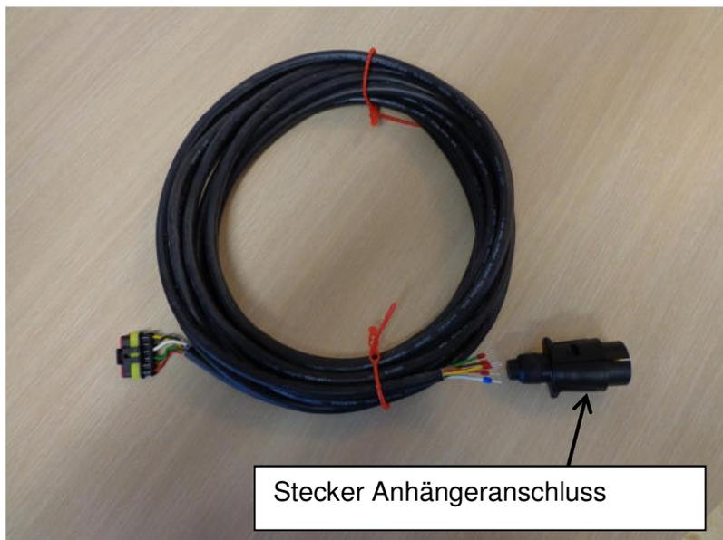
6. Stecker anschließen, Fahrzeug einschalten und Beleuchtung prüfen. Blinklicht li/re, Bremslicht, Schlusslicht. Nebelschlusslicht und Rückfahrlicht sind nicht vorhanden.
