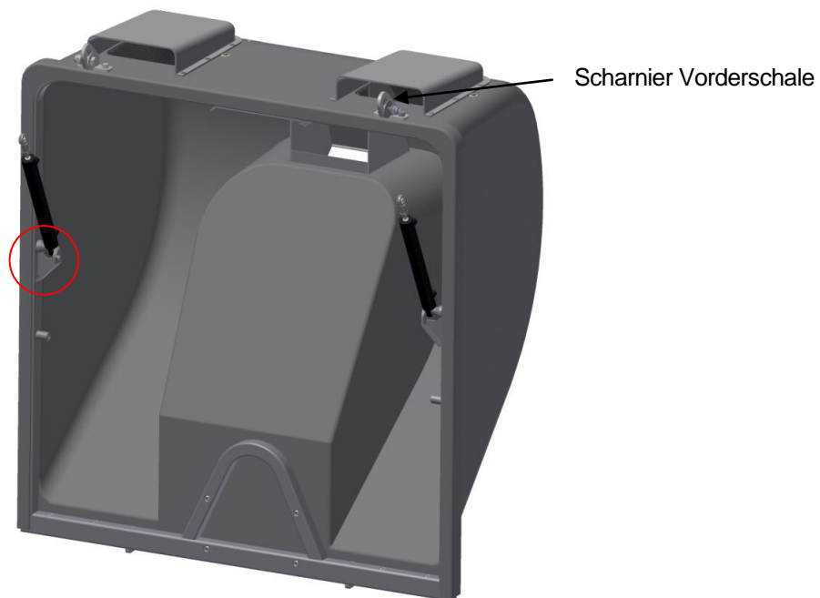
Abbildung 4: Vorderschale mit verstärkter Zylinderaufhängung (ab. 11.2017)
