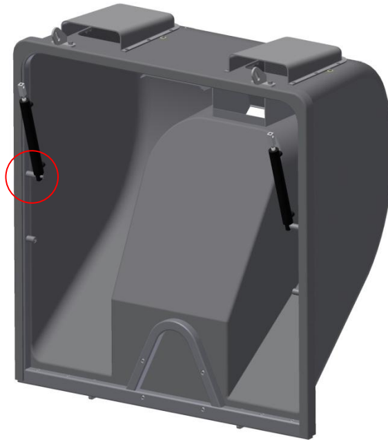
Abbildung 3: Vorderschale mit ursprünglicher Zylinderaufhängung (bis 10.2017)
