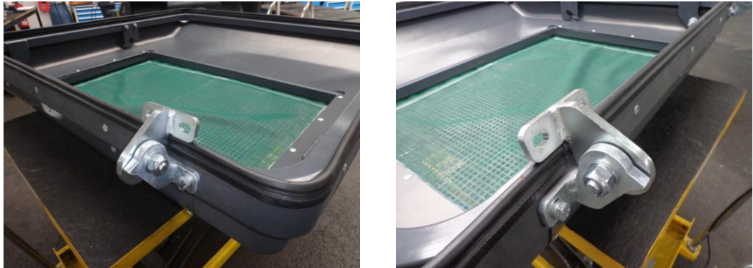
Abbildung 7: Hinterschale mit montiertem Scharnier
