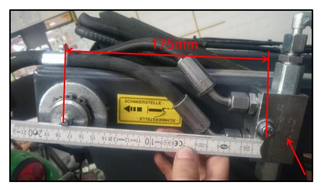
Das zweite Ventil bündig zum Träger positionieren und 410mm von Trägerkante bis zu Kante vom Ventil.
