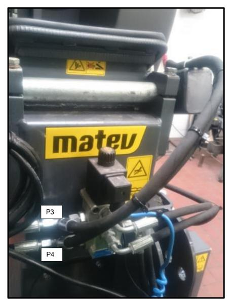
Falls nicht erst die Klappe aufmacht und dann die beiden Zylinder schwenken müssen P3 und P4 auf diesem Foto vertauscht werden.
