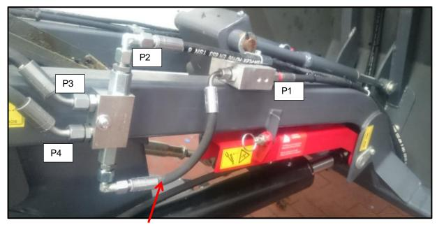
Die Ventile werden mit einem Schlauch mit der Länge von 250mm und einem 90° Bogen verbunden.
