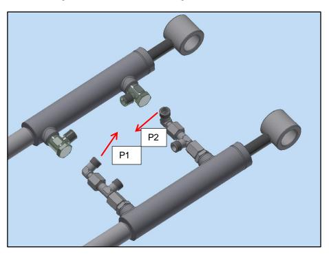
Schlauch P1: mit Länge 1350mm und 90° Bogen Schlauch P2: mit Länge 1500mm und 90° Bogen
