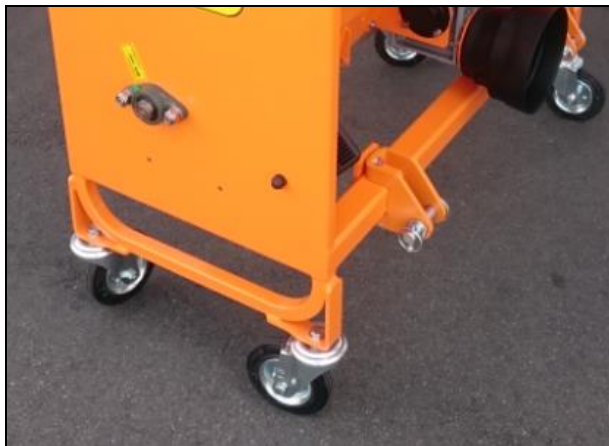
Bild 17: Radsatz montiert an Streuer
