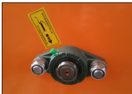
Bild 24: Stehlager in Fahrtrichtung links
